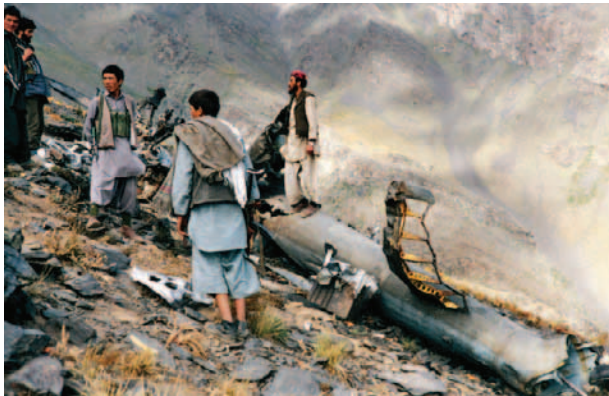
Моджахеды у обломков сбитого вертолета. Среди крупных частей узнаваема хвостовая балка вертолета Ми-8
